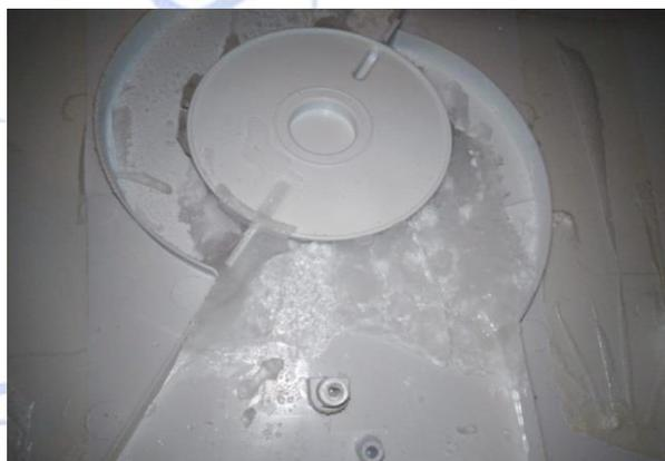
**Modification: Couper 2 mm de part et d'autre du clapet de ventilation**
