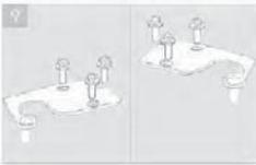
10. Vuelva a colocar el soporte superior y la puerta superior en su sitio. No apriete completamente los tornillos.
