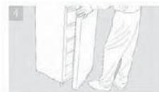
5. Verwijder de ondersteun door de schroeven los te maken. Verwijder de verstelbare poot en verplaats die van de linker- naar de rechterkant. Verwijder vervolgens de schroef aan de linkerkant.
