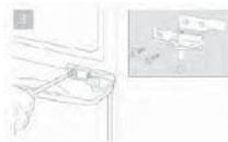
4. Retire la puerta inferior del eje de la bisagra inferior. Incline el frigorífico hacia atrás y colóquelo sobre una superficie firme.
