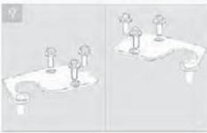
10. Remplacez le support supérieur en remettant en place la porte supérieure. Ne serrez pas complètement les vis.
