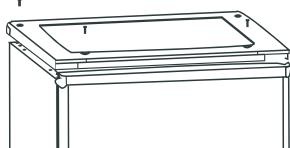
3. Gebruik een platkopschroevendraaier om het afdekblad vooraan te verwijderen.
