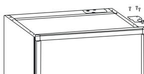
6. Verwijder de twee afneembare poten door de schroeven los te draaien.
