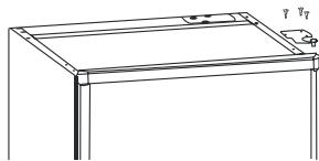
6. Die beiden abnehmbaren Füße entfernen, indem Sie die Muttern lösen.
