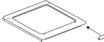
5. Nehmen Sie die obere Abdeckung ab, versetzen diese auf die linke Seite und schrauben sie fest an.
