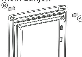
Verplaats het toebehoren **B** van de bovenste rand van de bovenste deur en zet het toebehoren **A**, een klein wisselstuk dat meegeleverd wordt in een klein zakje, vast.
