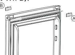
Versetzen Sie das Zubehörteil **B** am oberen Rand der oberen Tür und befestigen Sie das Zubehörteil **A**, das ein kleines abnehmbares, in einer kleinen Tüte geliefertes Ersatzteil ist.
