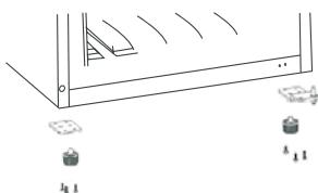
7. Schroef de schroeven van het afdekblad los en verwijder de schroeven, verplaats de pakking en zet deze vast.
