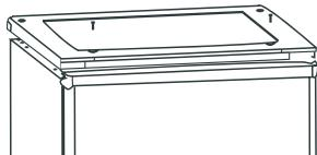
3. Verwenden Sie einen Flach-Schraubenzieher, um die vordere Abdeckung abzunehmen.
