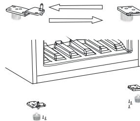
8. Remettez en place les caches de la partie supérieure en vissant les 4 écrous. Replacez les caches sur les vis.
