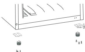
7. Dévissez et retirez les vis du cache, déplacez le joint et repositionnez-le. Remettez en place le pied amovible. Positionnez la porte inférieure de la bonne façon. Fixez-la en resserrant les vis.
