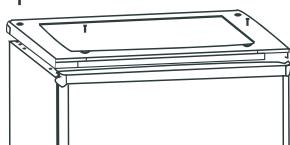
3. Utilisez un tournevis à lame plate pour retirer le cache avant.
