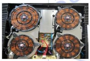
Déconnecter les fils d'alimentation de la platine gauche et reposer le dessus verre pour tester la plaque.
