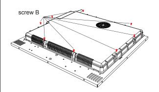
Step2: remove the screw B
