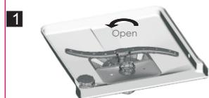
Etape 1: Tourner le filtre dans le sens contraire des aiguilles d'une montre, puis le soulever.
