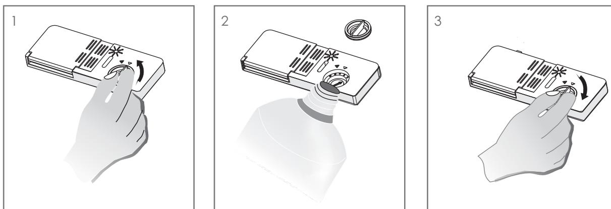
1. Pour ouvrir le distributeur, tournez le bouchon dans la direction de la flèche « open » (vers la gauche) et soulevez-le.
