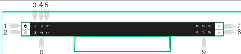
1. Bouton d'alimentation électrique : Pour mettre en Marche/Arrêt l'alimentation électrique.
