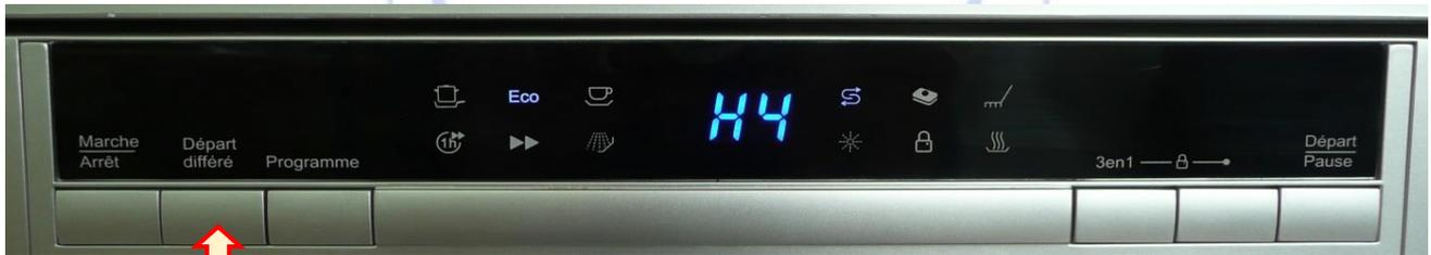
Appuyer sur "**Départ Différé**" pour modifier le réglage (possible de H0 à H7).
