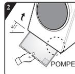
B: Avant d'installer la plaque inférieure antibruit, alignez et collez la laine d'absorption acoustique avec et le long de l'impression d'angle droit sur la plaque inférieure (cette procédure n'est pas nécessaire pour certains modèles sans laine d'absorption acoustique).
