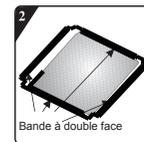
Retirez le papier de surface sur la bande à double face sur quatre côtés de la plaque inférieure.
