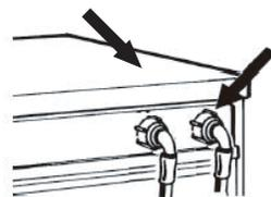
10 Vissez à la main le flexible d'arrivée sur le robinet, en serrant l'écrou.
