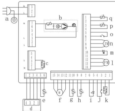
a: puissance b: compresseur c: dégivrage-chauffe d: panneau d'affichage
