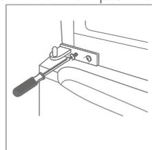
9. Placez la porte supérieure de nouveau. Assurez-vous que la porte soit alignée horizontalement et verticalement afin que le joint d'étanchéité soit fermé de tous les côtés avant de serrer définitivement la charnière supérieure. Ensuite, placez la charnière et vissez-la à l'avant de l'appareil.
