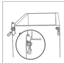
8. Faites-en sorte que la charnière du milieu soit inversée à 180 ° C, puis déplacez-là à gauche. Faites-la goupiller de charnière moyenne dans le trou supérieur de la porte inférieure, puis serrez les boulons.
