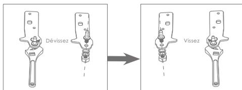
7. Reposez le support en ajustant la goupille de charnière inférieure. Remplacez les deux pieds réglables. Déplacez la porte inférieure dans la position inverse
