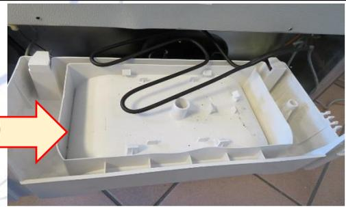
Coller la résistance sous le bac et couvrir les bords de la résistance d'adhésif aluminium (au besoin).
