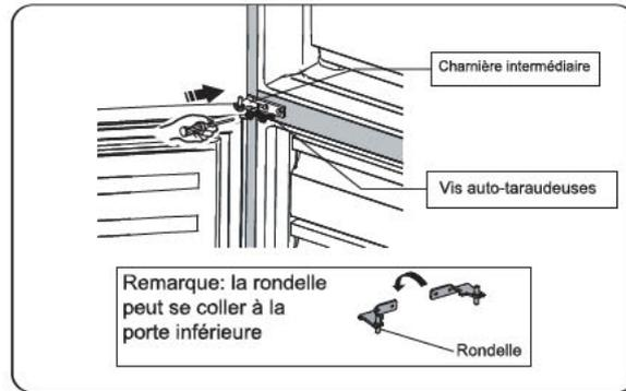
14. Transférez la porte supérieure à la position appropriée. Fixez le niveau de la porte, faites rentrer l'axe de la charnière centrale dans le trou inférieur de la porte supérieure.
