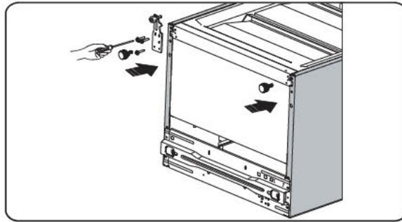
12. Transférez la porte inférieure sur position de propriété, ajustez la partie inférieure de la charnière, faites rentrer l'axe de charnière dans le trou inférieur de la porte inférieure, puis serrez les boulons.
