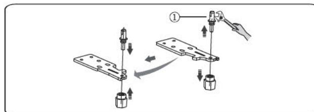
11. Remplacez la partie inférieure de charnière sur le côté gauche et la fixez à l'aide des vis autotaraudeuses spéciales de la bride. Remplacez les parties inférieures des pieds réglables d'un autre côté et fixez-les.
