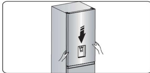
15. Déplacez la porte supérieure dans une position appropriée, puis fixez la pièce à l'aide de la vis ③. (Veuillez tenir la porte supérieure à la main lors de l'installation). Installez le couvercle de la charnière supérieure ② dans le coin gauche à l'aide de la vis ①.
