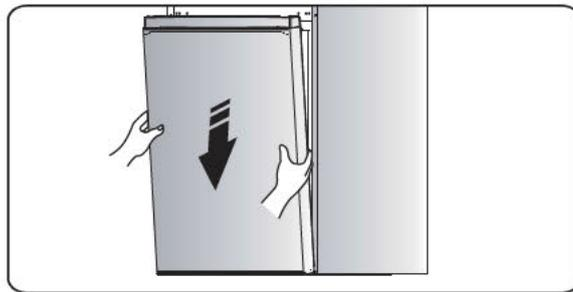
13. Insérez la porte inférieure dans l'axe de la charnière inférieure et maintenez-la en place. Tournez la charnière intermédiaire de 180°, changez la rondelle de l'axe du côté inférieur, ajustez la charnière intermédiaire à la position appropriée, puis installez-la en veillant à ce que la porte inférieure soit bien en place.
