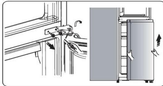
7. Placez la porte inférieure sur une surface lisse avec son panneau vers le haut. Desserrez la vis ③ et retirez les pièces ① et ②, puis installez la butée de porte gauche ④ fournie (dans le sac en plastique) sur le côté gauche et serrez-les fermement.
