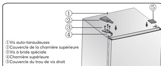
16. Installez le couvercle du trou de vis droit ⑤ dans l'angle supérieur droit du réfrigérateur.
