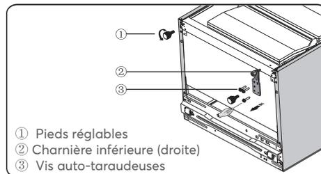
10. Retirez la pièce ① de la charnière inférieure (droite), desserrez la goupille de la charnière inférieure, déportez-la au trou inverse, puis serrez-la en place. Installez la pièce ① sur la goupille de la charnière inférieure.
