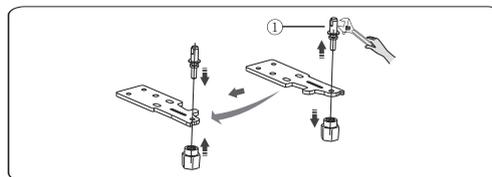
11. Remplacez la partie inférieure de charnière sur le côté gauche et la fixez à l'aide des vis autotaraudeuses spéciales de la bride. Remplacez les parties inférieures des pieds réglables d'un autre côté et fixez-les.
