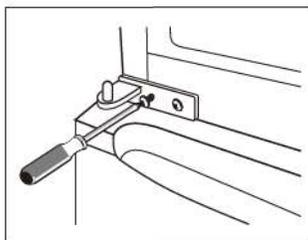
10. Remettez la porte supérieure en place. Assurez-vous que la porte est alignée horizontalement et verticalement afin que le joint soit fermé de tous les côtés avant de finalement serrer la charnière supérieure. Insérez ensuite la charnière supérieure et vissez-la en haut de l'unité.
