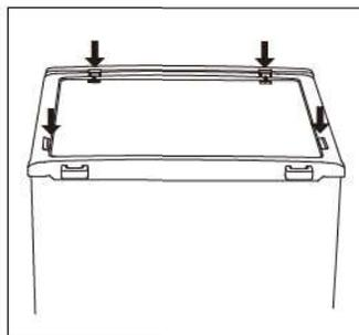
12. Détacher les joints des portes du réfrigérateur et du congélateur puis fixez-les après inversion.
