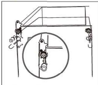
9. Renversez la charnière centrale et puis la replacer à la position gauche. Replacez l'axe de la charnière centrale dans le trou supérieur de la porte inférieure, puis vissez le boulon.
