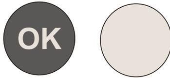
Pour la bonne conservation des denrées dans votre réfrigérateur et notamment dans la zone la plus froide, veillez à ce que dans l'indicateur de température apparaisse « OK ». Si « OK » n'apparaît pas, la température moyenne de la zone est trop élevée. Réglez le thermostat sur une position supérieure.
