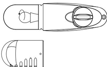
4. Visser la nouvelle ampoule dans le sens des aiguilles d'une montre
