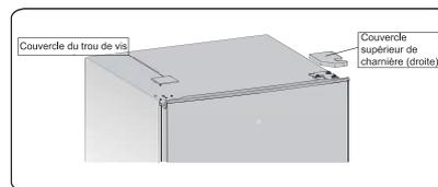
2. Dévisser les vis autotaraudeuses spéciales de la bride qui servent à fixer la partie supérieure droite de la charnière à l'aide d'un tournevis à douille de 8 mm ou d'une clé (en le faisant, veuillez soutenir la porte supérieure avec votre main).
