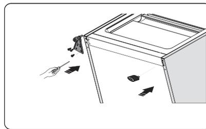
8. Transférer la porte à la position de propriété, ajuster la partie inférieure de charnière, introduire l'axe de charnière dans le trou inférieur de la porte.
