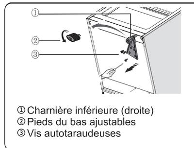
7. Replacer la partie inférieure de la charnière vers la gauche et la fixer avec les vis auto-taraudeuses spéciales de la bride. Replacer les parties inférieures des pieds réglables sur un autre côté et les fixer.
