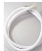
Le tuyau d'arrivée d'eau de la machine se termine par un connecteur femelle de 3/4". La canalisation doit donc comporter un connecteur mâle similaire ainsi qu'un robinet d'arrêt à proximité.
