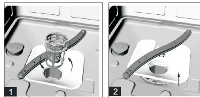
Tournez le filtre central et le micro-filtre dans le sens contraire des aiguilles d'une montre pour les retirer de l'appareil. Séparez les filtres.
