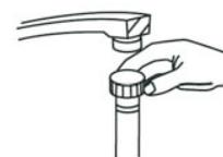
Vissez le connecteur droit du tuyau d'arrivée au robinet et serrez fermement; les rondelles doivent impérativement être bien en place à chaque extrémité du tuyau.
