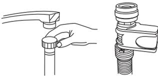
Raccordez le tuyau d'alimentation en eau froide à un raccord fileté de 1,9 cm (3/4") et veillez à ce qu'il soit bien serré. Si les tuyaux d'eau sont neufs ou s'ils n'ont pas été utilisés depuis longtemps, faites couler l'eau pour vérifier qu'elle est claire et sans impuretés. Si cette précaution n'est pas prise, il existe un risque que l'arrivée d'eau soit obstruée et que l'appareil soit endommagé.
