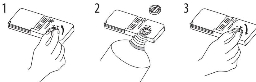
1. Pour ouvrir le distributeur, tournez le bouchon vers la flèche « ouvrir » (à gauche) et retirez-le en le soulevant.
