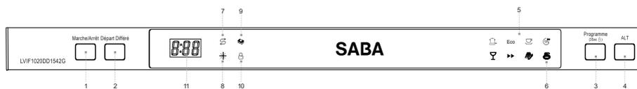
1. **Bouton Marche/Arrêt :** Pour mettre l'appareil sous tension/hors tension.
