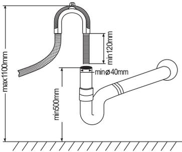
Installez le flexible de vidange de votre appareil sur le tuyau de vidange sans le plier.
