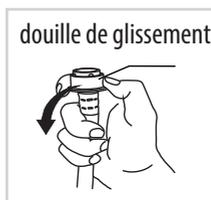
Appuyez sur la douille de glissement, insérez le tuyau d'arrivée d'eau dans l'orifice du robinet
