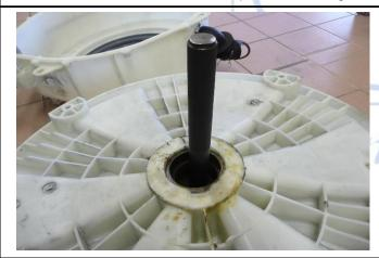
Après avoir changé de diamètre de disque, positionner le chasse roulement afin d'extraire à la fois le roulement intérieur et le joint spi.
