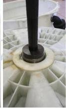
Positionner le roulement extérieur, frapper pour l'enfoncer en butée du moyeu: lors de la frappe le bruit "sourd" devient "métallique".
