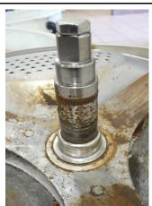
Mettre du dégrippant au niveau du croisillon et laisser agir quelques minutes. Placer le tasseau sur la vis de poulie, frapper à l'aide du marteau pour sortir le tambour.
