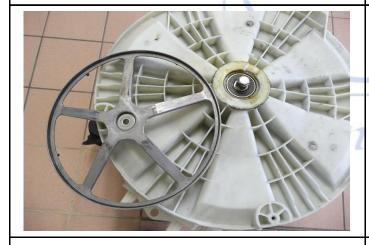
Démonter la poulie et repositionner la vis de poulie sur le croissillon en la serrant à fond.
