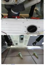
Retirer les axes des amortisseurs et démonter la durite au niveau de la pompe de vidange.
