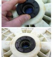
Positionner le roulement intérieur, frapper pour l'enfoncer en butée du moyeu: lors de la frappe le bruit "sourd" devient "metallique".
