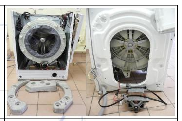
Retirer le dessus et la façade du lave linge puis démonter les contre-poids supérieurs et avant, décrocher le moteur.
