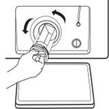
4. Ouvrez le filtre en tournant dans le sens inverse des aiguilles d'une montre
