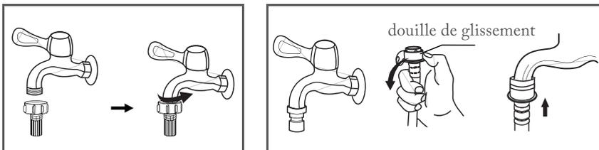
Robinet avec filetage et tuyau d'arrivée d'eau
