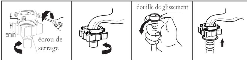
Desserrez l'écrou de serrage et les quatre boulons
