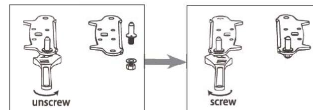
6. Réajustez le support en ajustant l'axe de la charnière inférieure. Remplacez les deux pieds réglables.
