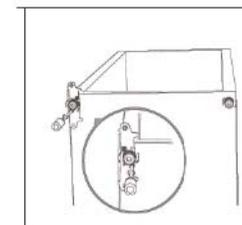
7. Remettez la porte supérieure en place. Assurez-vous que la porte est alignée horizontalement et verticalement afin que les joints soient fermés de tous les côtés avant de finalement serrer la charnière supérieure.
