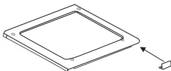
5. Retirez le cache supérieur, faites-le passer du côté gauche et vissez-le fermement.
