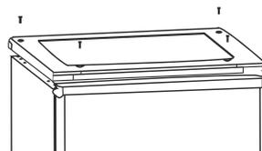
3. Utilisez un tournevis à lame plate pour retirer le cache avant.
