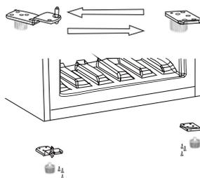
8. Remettez en place les caches de la partie supérieure en vissant les 4 écrous. Remettez les caches sur les vis.
