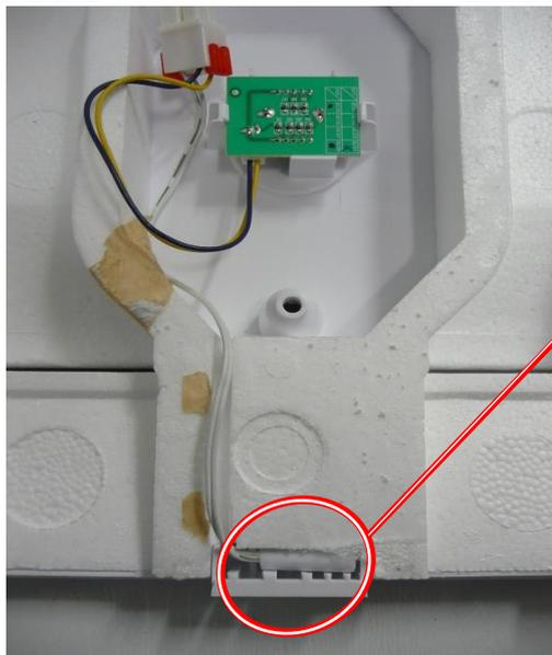
Sélecteur de température et sonde réfrigérateur
