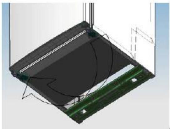
7. Mettez le pied réglable de l'autre côté et ajustez-le de manière à ce que l'appareil soit d'aplomb.
