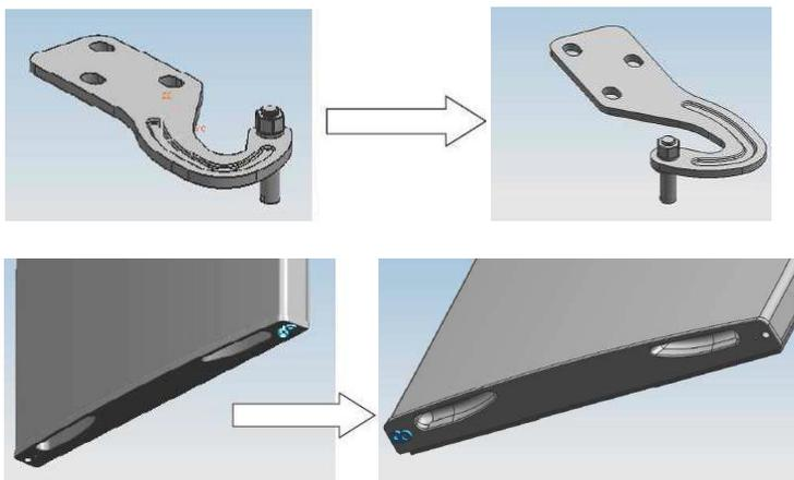
4. Faites basculer l'appareil à un angle de  $45^\circ$  et enlevez les vis de la charnière du bas.
