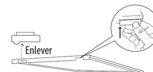
3. Dévisser les vis et retirer la charnière supérieure. Déposer la porte du compartiment congélateur.
