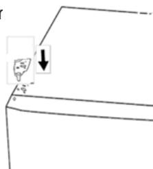
6. Reposer et fixer le capot supérieur. Remettre les bouchons cache trous.
