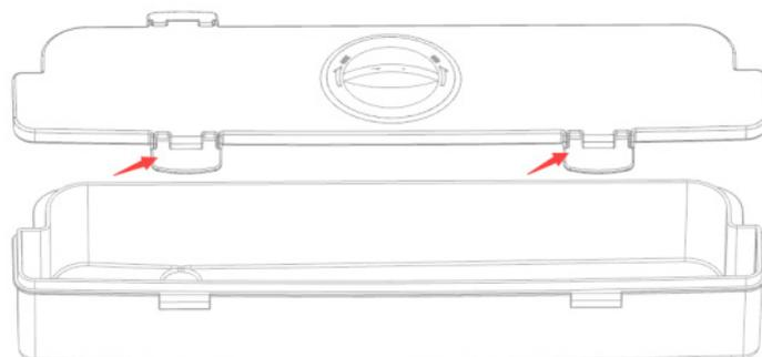
4. Démontez les pièces, nettoyez l'intérieur et l'extérieur du réservoir avec une éponge ou un chiffon doux. Utilisez de l'eau chaude ou 1 cuillère à café de bicarbonate de soude dissous dans 1,2 litre d'eau.
