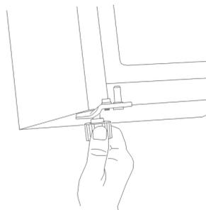
2. Enlever la butée de la porte du compartiment réfrigérateur et la remettre sur le côté opposé. Reposer la porte en alignant le trou inférieur au canon de la charnière, veiller à ce que son alignement soit parfait par rapport au corps du réfrigérateur.
