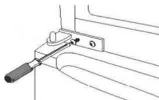
4. Enlever la butée de la porte du compartiment congélateur et la remettre au côté opposé. Reposer la porte en alignant le trou inférieur au canon de la charnière intermédiaire, veiller à son alignement soit parfait par rapport au corps du réfrigérateur.
