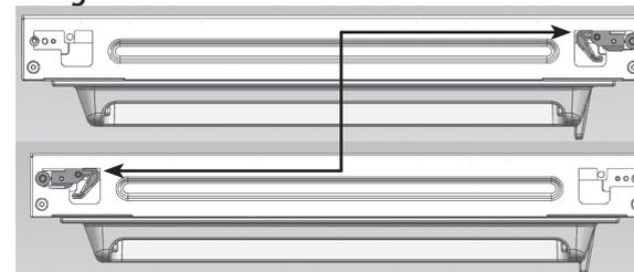
c. Utilisez un outil pour enlever l'axe et les deux butoirs sur la charnière du bas, puis assemblez-les à l'endroit illustré sur la figure ci-dessous.
