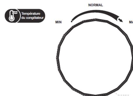
La température du congélateur est contrôlée par le bouton du thermostat situé à l'intérieur du réfrigérateur. Le bouton peut être ajusté de «MIN» (Moins froid) à «MAX» (Plus froid).
