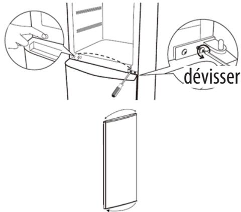
4. Retirez les vis inférieures et la charnière inférieure de la partie de l'appareil basse de l'appareil. Inversez la charnière inférieure, et fixez-la avec les vis inférieures sur le côté opposé en bas de l'unité. Remplacez soigneusement la porte inférieure en position, en l'insérant dans la charnière inférieure.
