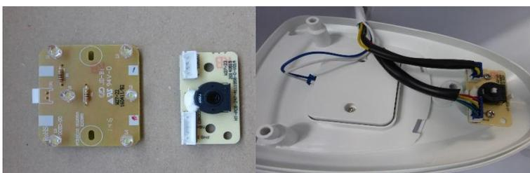
Éclairage Led et potentiomètre de température
