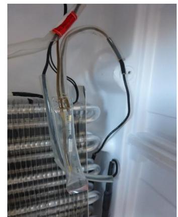
Fusible thermique et résistance de dégivrage
