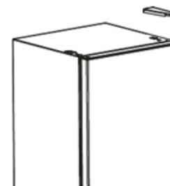
2. Enlevez la charnière supérieure. Soulevez la porte supérieure et placez-la sur une surface souple pour éviter de la rayer. Retirez le bloc de la porte, la vis et le tube en plastique du dessous de la porte supérieure et déplacez-les de l'autre côté. Vous devrez replacer le bloc de la porte du côté opposé.
