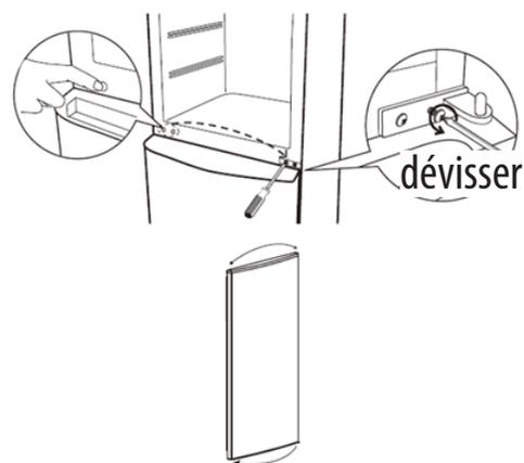
4. Retirez les vis inférieures et la charnière inférieure de la partie de l'appareil basse de l'appareil. Inversez la charnière inférieure, et fixez-la avec les vis inférieures sur le côté opposé en bas de l'unité. Remplacez soigneusement la porte inférieure en position, en l'insérant dans la charnière inférieure.
