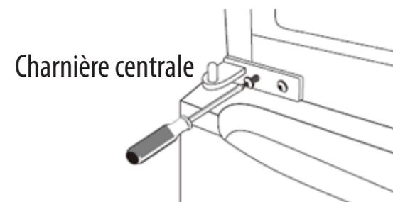
6. Remplacez soigneusement la porte supérieure en place, en l'insérant dans la charnière centrale.
