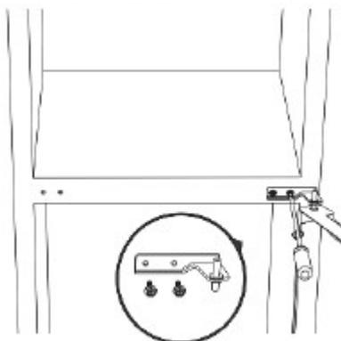
5. Remplacez le couvre-charnière de la charnière de la porte inférieure sur le côté opposé. Ensuite, soulevez la porte inférieure et placez-la sur une surface souple pour éviter les rayures et les dommages.
