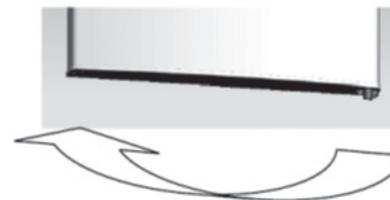
5. Reposer la porte inférieure en prenant soin de son alignement avec le corps de l'appareil.
