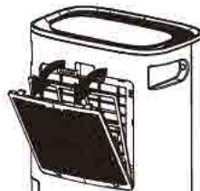
2. Utilisez un aspirateur pour enlever la poussière accumulée sur le filtre. Si nécessaire, utilisez de l'eau tiède (<40 °C) pour nettoyer le filtre. Une fois le nettoyage effectué, séchez complètement le filtre puis remettez-le.
