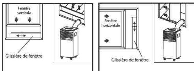
3. Faites glisser le panneau C (sans trou) ou le panneau B (avec trou) dans le panneau A, puis utilisez les vis pour fixer fermement les panneaux à la fenêtre aux deux positions D. (Voir la figure ci-dessous.)
