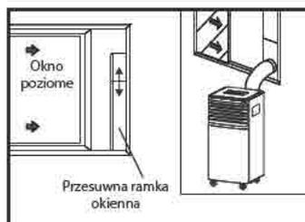
3. Nasuń panel C (bez otworu) lub panel B (z otworem) na panel A, a następnie mocno przykręć panele do okna za pomocą wkrętów w dwóch położeniach, oznaczonych literą D. (Patrz rysunek poniżej).
