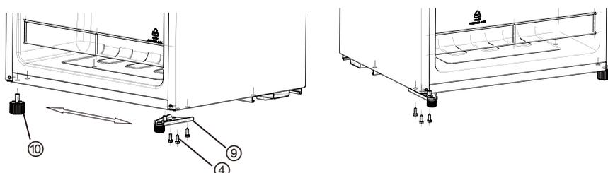
5. Setzen Sie die oben erwähnte Glastür auf das untere Scharnier, installieren Sie die Türachsenhülse ⑥ hinten und befestigen Sie das obere Scharnier ⑤. Richten Sie die Tür mit dem Schrank aus und prüfen Sie die Dichtigkeit der Dichtung, dann installieren Sie alle Verzierungen ① ②.
