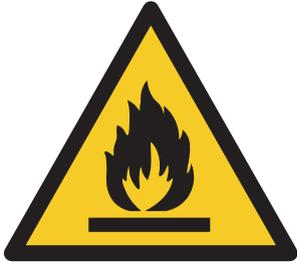
47. WARNUNG! Feuergefahr - zündfähiges Material. Bei der Instandhaltung und Entsorgung das Gerät von Zündquellen fernhalten. Auf der Rückseite des Geräts befinden sich zündfähige Materialien.
