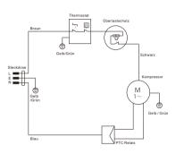
Modell: 5948487/00 220-240V~ Nennspannung: Nennstrom: 0.64 Nennfrequenz: 50Hz Gesamt Nutzvolumen: 801 Nutzvolumen des Kühlschranks: 801 N/ST Klimaklasse: R600a(19g) Kältemittelgas: Energieverbrauch von e32: 0.439kWh/24h Jährlicher Energieverbrauch: 105kWh/a
