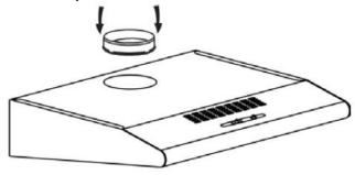
Fixer la hotte à l'aide des vis (longueur maximale de 35mm), écrous et rondelles fournis.
