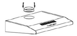
Ouvrez le filtre à graisses, fixez la hotte avec les 2 vis fournies. (Longueur maximale de 30 MM)
