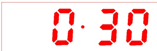
Fig. 23 Schéma d'affichage du symbole d'annulation de la fonction « Auto » (une fois le temps de cuisson terminé)
