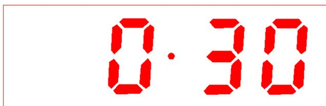
Fig. 18 Schéma de l'affichage du symbole d'annulation de la fonction « AUTO » (une fois le temps de cuisson fini)
