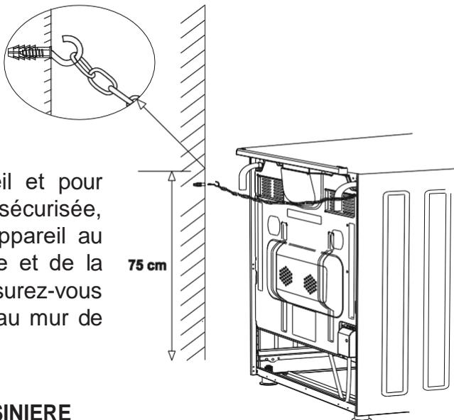
Avant d'utiliser l'appareil et pour garantir une utilisation sécurisée, assurez-vous de fixer l'appareil au mur à l'aide de la chaîne et de la vis à crochet fournis. Assurez-vous que le crochet est vissé au mur de manière sécurisée.
