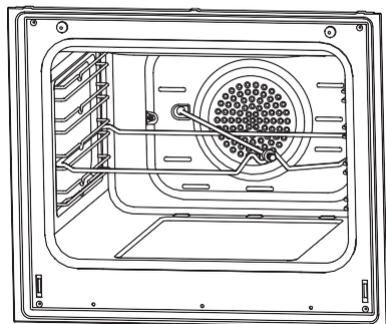
Placez la broche à rôtir sur le cadre. Faites glisser le cadre de la broche à rôtir dans le four au niveau souhaité. Installez le récipient de récupération à travers la partie inférieure pour la récupération des aliments. Ajoutez de l'eau dans le récipient de récupération pour un nettoyage facile. N'oubliez pas de retirer le plastique de la broche à rôtir. Après la cuisson, vissez la poignée plastique sur la brochette et retirez les aliments du four.
