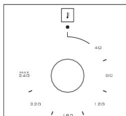
Utilisé pour déterminer la température de cuisson du plat à cuire au four. Après avoir placé la nourriture à l'intérieur du four, tournez le bouton pour ajuster le réglage de température souhaité entre 40-240 °C. Pour la température de cuisson de différents aliments, consultez le tableau de cuisson.
