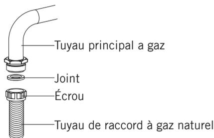
2. Le raccordement du gaz naturel doit être effectué par un service agréé. Pour le raccordement du gaz naturel, placez le joint dans l'écrou à l'extrémité du tuyau de raccordement du gaz naturel. Tournez l'écrou pour brancher le tuyau au tube principal de gaz. Terminez le raccordement en contrôlant les fuites de gaz.
