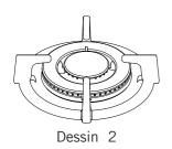
La spécificité du brûleur à gaz Wok est sa cuisson rapide. Ayant un système de flamme à double anneaux, il permet une répartition homogène sur la base de la casserole à haute température. Ceci est idéal pour les cuissons courtes et à très haute température. Lorsque vous souhaitez utiliser une casserole normale sur une cuisinière Wok, il est nécessaire de positionner l'adaptateur de casserole wok sur la cuisinière.
