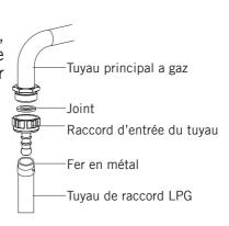
**REMARQUE :** Le régulateur à brancher sur la bonbonne LPG doit être de 300 mmSS.
