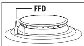
**Dispositif de sécurité contre la coupure de flamme (FFD);** Fonctionne instantanément lorsque le mécanisme de sécurité est activé en raison du liquide qui se déverse sur les plaques supérieures.
