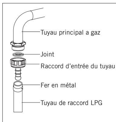
Pour le raccordement GPL (bonbonne), placez les fers en métal au tuyau venant de la bonbonne GPL. À condition de chauffer dans l'eau bouillante, placez une extrémité du tuyau sur le raccord d'entrée du tuyau derrière l'appareil en poussant très fort. Puis, en plaçant le fer vers la partie de l'extrémité du tuyau, vissez avec tournevis. Le joint et le raccord d'entrée du tuyau nécessaire pour la connexion sont comme indiqués sur la figure.
