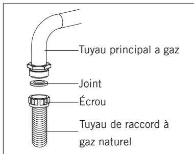
**AVERTISSEMENT:** Le raccordement du gaz naturel doit être effectué par un service agréé. Pour le raccordement du gaz naturel, placez le joint dans l'écrou à l'extrémité du tuyau de raccordement du gaz naturel. Tournez l'écrou pour brancher le tuyau au tube principal de gaz. Terminez le raccordement en contrôlant les fuites de gaz.
