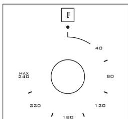
**Thermostat :** Utilisé pour déterminer la température de cuisson du plat à cuire au four. Après avoir placé la nourriture à l'intérieur du four, tournez le bouton pour ajuster le réglage de température souhaité entre 40-240 °C. Pour la température de cuisson de différents aliments, consultez le tableau de cuisson.
