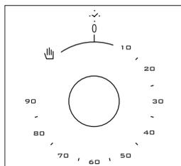
**Minuterie mécanique** Utilisée pour déterminer la période pour la cuisson au four. Lorsque la durée réglée est expirée, l'alimentation des feux est coupée et un signal d'avertissement sonore est émis. La minuterie mécanique peut être ajustée à la période souhaitée entre 0 et 90 minutes. Pour les périodes de cuisson, consultez les tableaux de cuisson.
