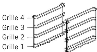
Il est important de placer correctement la grille dans le four. Ne laissez pas la grille toucher la paroi arrière du four. Les positions de la grille sont indiquées dans la figure suivante. Vous pouvez placer un plateau profond ou un plateau standard sur les grilles inférieures et supérieures.
