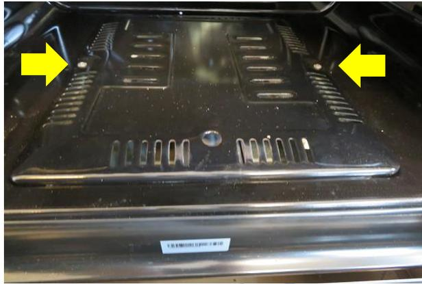
Retirer la vis sur l'avant et détacher thermocouple et bougie avant de sortir le bruleur.
