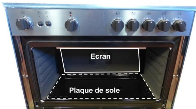
L'accès à l'injecteur du four nécessite d'enlever plusieurs éléments du four:
