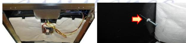
Soulever l'isolation arrière et desserrer la vis
