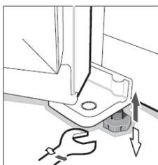
Lorsque le réfrigérateur se trouve dans sa boîte d'emballage, les pieds en plastique sont serrés. Après l'avoir sorti de la boîte d'emballage pour le placement, assurez-vous d'ajuster les deux pieds avant en plastique jusqu'à ce que la hauteur soit adaptée ; il suffit d'ajuster deux pieds en plastique avec une clé ou directement à la main.
