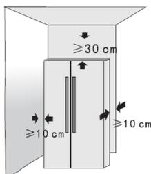
Le réfrigérateur doit être placé sur un sol dur et plat ;
