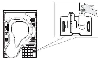
Étape 1 : Retirer le tuyau d'évacuation du connecteur du tuyau à l'aide d'une pince
